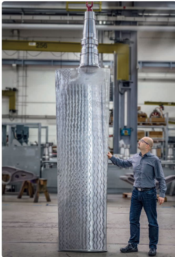
Schaufel eines Voith Schneider Propellers (VSP): Die Voith Group setzt für eine wirtschaftliche standortübergreifende Produktion auf eine zentrale Kalkulation und Arbeitsplanung mit HSi.
