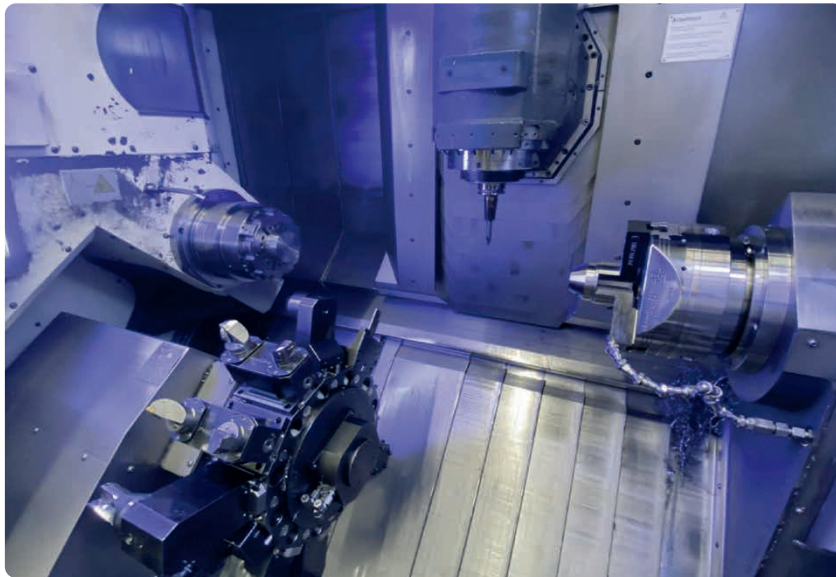
Blick in den Arbeitsraum des Drehfrasenzentrum CTX DFZ SK ausgelegt fur eine 6-Seitenbearbeitung im Werk Brandenburg der Heidelberger Druckmaschinen AG
